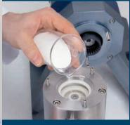
Une fois démonté et le couvercle frontal ouvert, le compartiment de broyage se laisse facilement remplir avec les billes de broyage.
